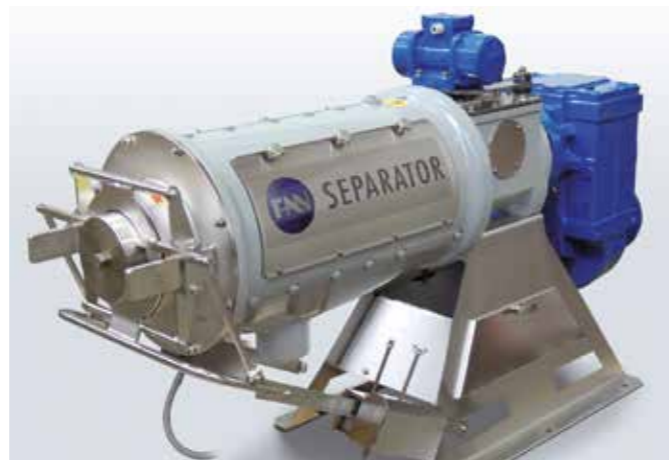
Специальный прессовый шнековый сепаратор для BRU
