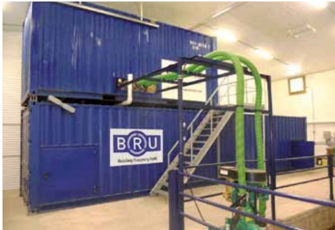
Установка для производства подстилки на ферме с поголовьем 2000 коров в штате Манитоба (Канада)
